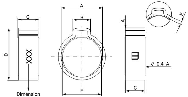
Ce modèle est très souvent utilisé pour des diamètres de flexibles très réduits. Donc il peut se donner le cas que le flexible soit excessivement souple et pourtant avoir des pertes d'étanchéité. Dans ce cas, la bague intégrée réalise une fonction clé afin de garantir l'étanchéité, mais en même temps de protéger la gomme, pour éviter ainsi des possibles endommagement du tube.
