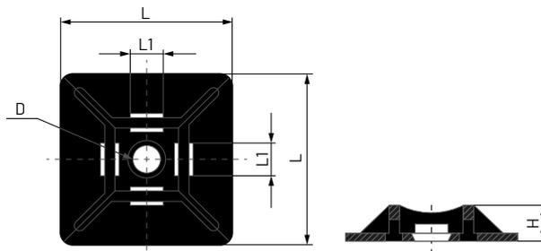
Les bases adhésives disponibles en 2 couleurs, noir et blanc et différentes tailles pour différentes largeurs de brides en nylon sont idéales pour réaliser des fixations rapides sur des murs lisses, qui sont maintenus par une bride sans avoir besoin de percer des trous. La base adhésive du côté opposé où elle adhère au mur comporte 4 cavités, sur chacun de ses côtés, à travers lesquelles passe la bride en nylon et pour pouvoir fixer l'élément souhaité.
