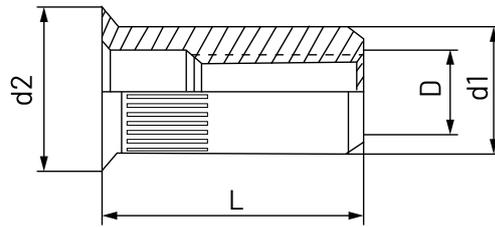
Les écrous à sertir permettent, en plus d'assembler plusieurs tôles, de réaliser l'assemblage d'un élément fileté. Le modèle à tête basse est appliqué lorsqu'il est nécessaire que l'écrou ne dépasse pas de la partie où il a été monté.
