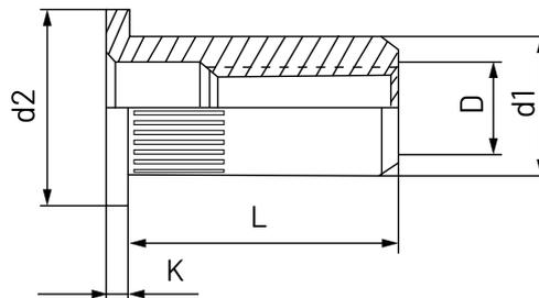
Les écrous à sertir permettent, en plus d'assembler plusieurs tôles, de réaliser l'assemblage d'un élément fileté.
