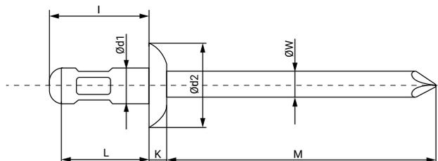
Les rivets multigrip sont utilisés pour assembler tous types de matériaux métalliques ainsi que des matériaux souples ou combinés. Ils sont très polyvalents car ils ont une capacité de rivetage qui s'adapte à plusieurs épaisseurs en une seule mesure. Il a une grande tolérance au moment de l'application puisqu'il s'adapte parfaitement au trou de montage et offre une semi-étanchéité.
