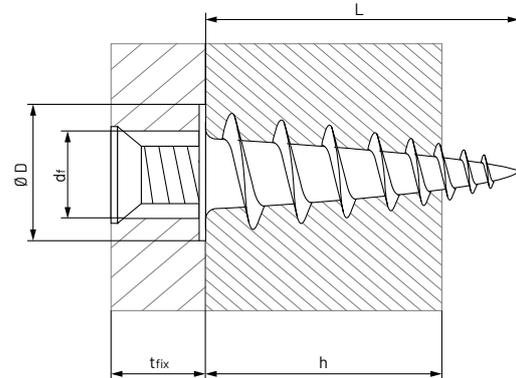
La cheville nylon à plâtre est particulièrement adapté aux plaques de carton, de plaques de plâtre. En entrant dans les espaces creux, il se dilate et permet une adhérence parfaite sur ces types de surfaces.
