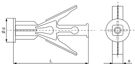
Le cheville nylon avec ailettes est particulièrement adapté pour le carton, le plâtre et les plaques de plâtre. En entrant dans les espaces creux, il se dilate et permet une adhérence parfaite sur ces types de surfaces.
