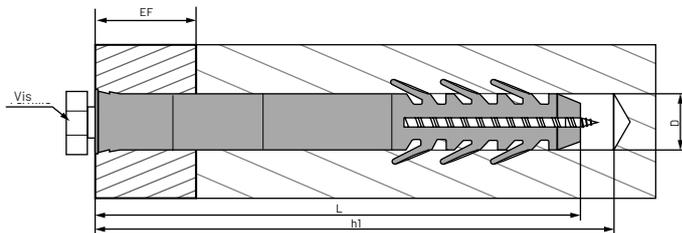
La cheville longue en nylon avec vis hexagonale est en polyamide 6.6 et est particulièrement adaptée pour supporter des charges légères dans des matériaux pleins et creux. L'assemblage se fait avec une douille hexagonale rapidement et facilement.
