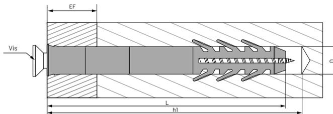
La cheville longue en nylon est en polyamide 6.6 et est particulièrement adapté pour supporter des charges légères dans des matériaux pleins et creux. L'assemblage se fait au marteau rapidement et facilement.
