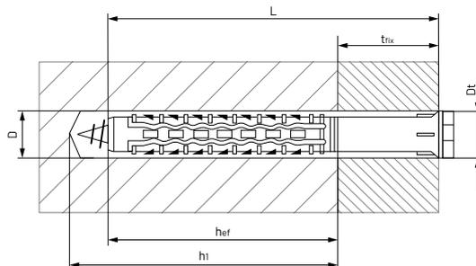
Cheville nylon en polyamide 6.6 qui intègre une vis à empreinte hexagonale. Ce sont des chevilles d'une longueur minimale de 80 mm et conçues pour fixer des éléments d'épaisseurs supérieures à 10 mm. Ils sont valables pour les matériaux pleins et creux et ont un système d'expansion ou de nouage selon la base sur laquelle vous travaillez, ce qui rend l'application totalement sûre.
