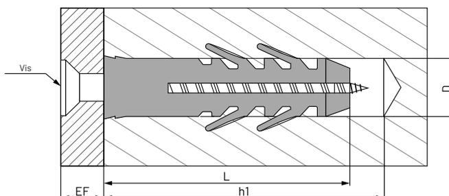
La cheville nylon standard est en polyamide 6.6 et est indiquée pour réaliser des fixations légères sur des matériaux solides, tels que béton, pierre, briques pleines. Ses ailes latérales permettent d'exercer un frottement dans le trou qui empêche le bouchon de tourner sur lui-même au moment de l'enfilage.
