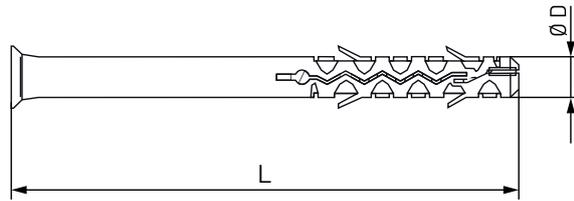
Il est fini avec une rondelle fraisée qui empêche le bouchon d'entrer dans le trou. Ses dimensions rendent la fixation effectuée très efficace et avec sa géométrie, une fois l'élément de fixation vissé dans le bouchon, il lui fait acquérir une déformation et se dilater, restant fixé sur les parois du trou. Il vient dans une couleur orange.
