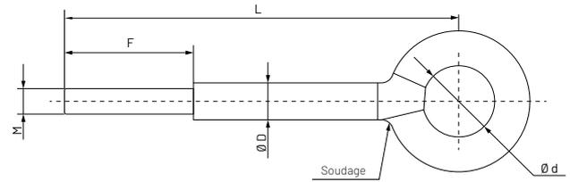
Ancre avec filetage métrique qui permet de l'enfiler dans la cheville métallique M8 pour façades et échafaudages, une fois filetée, elle active le système de cheville métallique qui se dilate à l'intérieur du trou en générant une pression sur les murs, laissant une fixation hautement sécurisée. La bague de 24 mm permet d'insérer tout élément facilitant la fixation.
