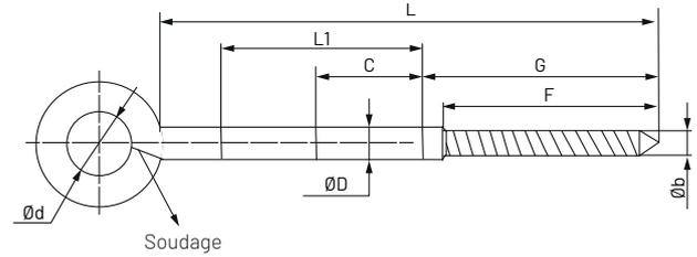
Ancre conçue pour fonctionner avec le Cheville nylon polyamide de 14 mm de diamètre. Idéal pour le béton armé, le béton, le béton creux, le béton cellulaire, la brique pleine, la brique creuse, la pierre, etc. Son anneau de diamètre 24 mm permet de fixer n'importe quel élément bien que son utilisation soit très étendue en échafaudage. Il existe des rallonges pour fixer les échafaudages aux façades et que son extrémité est conçue pour ce type d'ancrage.
