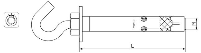
Le fonctionnement est le même que les chevilles métalliques. Il faut préalablement percer un trou où loger l'ancrage et en dilatant le manchon une fois le crochet enfilé, l'ancrage est réalisé par pression sur les parois du matériel de base. Le crochet permet de maintenir l'élément à fixer.
