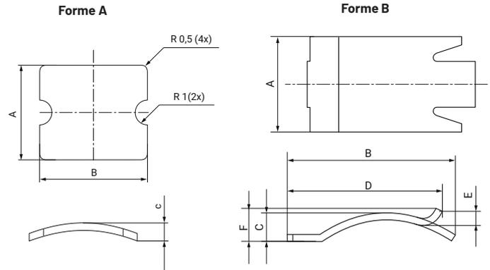
Le clip bouton est utilisé pour la fixation d'éléments en plastique, moulés ou boutons de commande.
