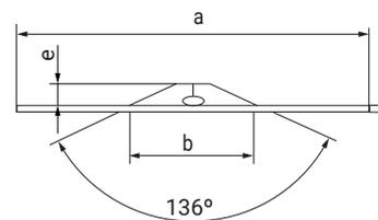
La rondelle à fixation spéciale, tout comme la tige qui viendra être logée dans son orifice central, sert à fixer les panneaux isolants en fibre de verre.
