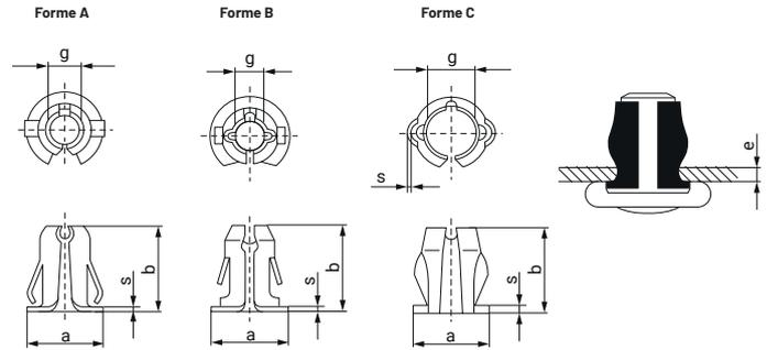
Le clip tubulaire SCL forme partie d'un groupe spécifique parmi les fixations qui requiert l'utilisation d'un rivet comme élément supplémentaire dans l'assemblage.
