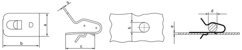
Le clip pour câble SCO est un élément de fixation qui par le biais d'une simple pression offre un montage aisé par la face extérieure du panneau et sur toute facette de la ligne de montage. Il est démontable ainsi que récupérable. La flexibilité du clip facilite le placement en toute sécurité de tringles, câbles tuyaux, tuyauteries, etc... ce clip permet une grande variation dans son diamètre de montage.
