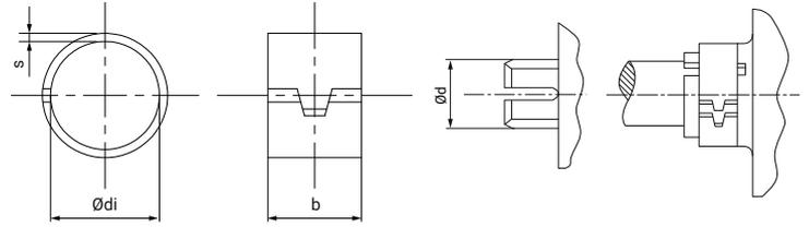
La bague de compression SCB est une bride cylindrique sectionnée en forme de dent sur l'un des ses côtés, pour permettre une introduction aisée de l'axe utilisé et provoquer la compression nécessaire pour éviter tout mouvement radial entre les éléments à fixer.
