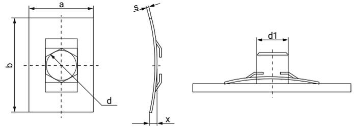
La fixation rapide pour axes SRR est un élément de fixation rectangulaire avec l'orifice d'entrée de l'axe situé dans son centre. Cette pièce est convenable pour les montages qui ne doivent pas être habituellement démontés, étant donné le fait que pour ce faire, il faut la rompre.
