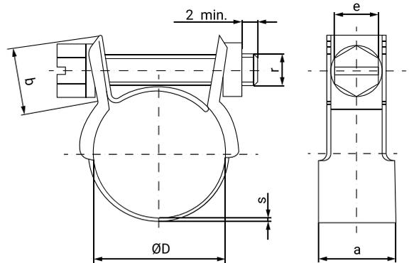
Grâce à l'acier utilisé le collier de serrage Normal, permet une déformation convenable lors de sa pose, s'adaptant parfaitement au tuyau avec un couple de serrage correct, mais en même temps soigneux.
