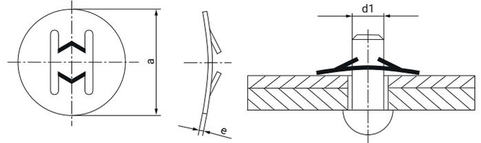
La fixation rapide circulaire SRC est un élément de fixation convenable pour les montages qui ne doivent pas être habituellement démontés, étant donné le fait que pour ce faire, il faut le rompre.
