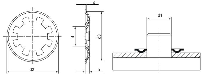
La fixation rapide circulaire pour Axes SRM est un élément de fixation convenable pour les montages qui ne doivent pas être habituellement démontés, étant donné le fait que pour ce faire, il faut le rompre.
