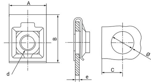
L'écrou cage spécial TCL est un élément de fixation composé de deux languettes avec un positionnement de pointage extérieur qui offre une double pression élastique.
