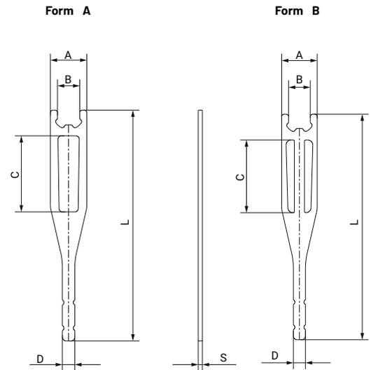
Ces fourches sont conçues pour appliquer des rondelles DIN 6799 car leur montage est difficile à la main. La fourche capte la rondelle DIN 6799 afin qu'elle soit complètement fixée sans possibilité de la décoller et permet également d'appliquer la force nécessaire. Une fois la rondelle posée sur la fourche, l'application peut être effectuée et logée là où elle correspond lors du démontage de la fourche, la rondelle restera appliquée sur l'arbre axial.
