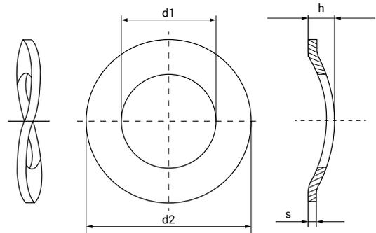
Ce type de rondelle s'utilise dans des montages sur aluminium, plastique, isolants, etc...
