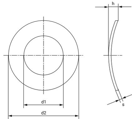
Ce type de rondelle s'utilise dans des montages sur aluminium, plastique, isolants, etc...
