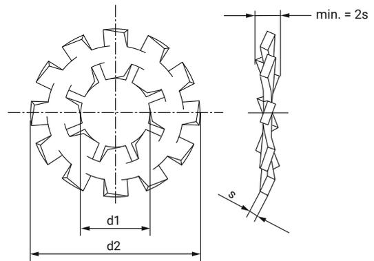
A utiliser dans des montages de tôle d'acier qui exigent des orifices ou des rainures bien supérieures au diamètre de la vis. A utiliser également lorsque l'on veut obtenir des pressions de blocage qui soient uniformément réparties sur la surface d'appui. Ce type de rondelle est aussi très utile dans des fixations de deux pièces où l'on cherche à empêcher les déplacements latéraux en s'assurant le positionnement.
