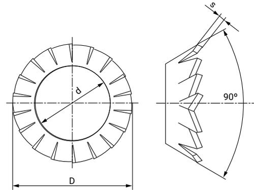
Les rondelles dentées selon la norme DIN 6798 nous permettent d'immobiliser des éléments d'union, en particulier, écrous, vis et boulons, soumis à vibrations, en maintenant le couple de serrage constant sur tout élément de fixation dans n'importe quel montage mécanique, électrique et électronique.
