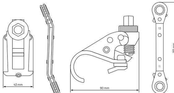
Cet outil est un accessoire qui est utilisé avec le tendeur et permet de réaliser la coupe finale sans laisser de pièces dépassant du diamètre fixe, évitant ainsi les dommages dus aux rayures ou aux déchirures.
