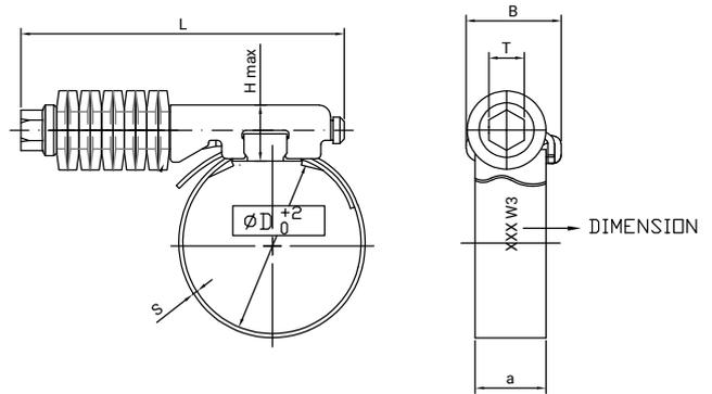
La vis est équipée de rondelles coniques spéciales qui adaptent leur comportement en fonction des vibrations et des changements de température qui se produisent dans l'application.
