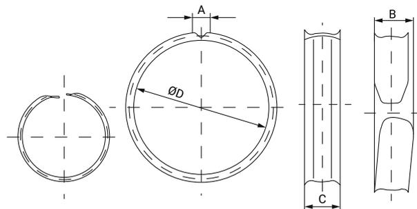
El aro de seguridad para abrazaderas ASFA L con un ancho de banda de 9 mm está pensado y diseñado para dar una mayor protección al tubo sobre el sistema de fijación de la abrazadera.
