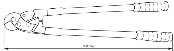
Es ideal para cortar cables de mayor diámetro, ya que la longitud de su mango permite realizar una mayor palanca y en consecuencia la presión realizada sobre el cable a cortar es mayor, esto también permite que realicemos una fuerza menor en el momento de realizar el corte. Su mango ergonómico y auto deslizante permite trasladar la fuerza sin obstáculos y sin sufrir daños en las manos.
