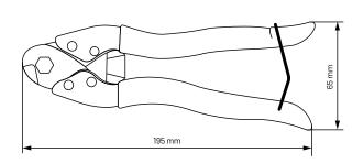
Permite realizar cortes precisos y limpios realizando la manipulación con una sola mano. Está pensada para ejecutar cortes de cable de acero de diámetros pequeños. Su ergonomía permite realizar la fuerza necesaria sin producir daños en la mano y además su mango de goma es auto deslizante.
