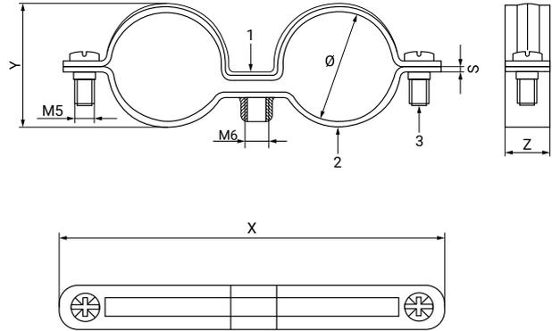
Esta abrazadera va fijada habitualmente en los techos y nos permite pasar dos tubos paralelos diámetro que deseemos. Se fija a la pared a través de un tornillo tirafondo y un taco y posteriormente se realiza el enroscado de la abrazadera doble.
