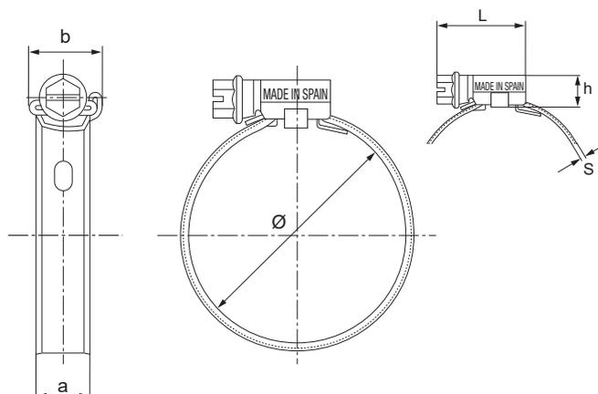
Con el objetivo de minimizar los costes de ensamblaje en las líneas de montaje, especialmente en la industria del automóvil, Mikalor ha desarrollado la abrazadera ASFA con taladro de pre-posicionamiento,
