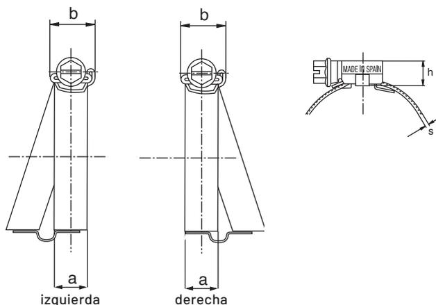
Las abrazaderas ASFA S de doce milímetros de ancho de banda y fabricadas con un puente o con dos puentes son una solución ideal para el montaje en tubos con espiral de acero en el interior.
