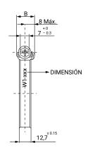
Las abrazaderas ASFA L con aro interior inoxidable se suministran montadas y están diseñadas para dar una mayor protección al tubo cuando se producen fuertes vibraciones durante largos periodos de tiempo.
