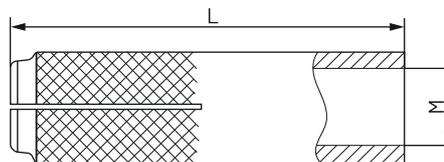
Este anclaje es de aplicación muy sencilla y funciona por expansión. Mediante un golpe en su interior, con los denominados expansionadores, desplaza un cono que está insertado en su interior, de manera que expansiona el anclaje por su parte inferior, lo que provoca un rozamiento en las paredes del agujero realizado y de esta manera se realiza el anclaje.
