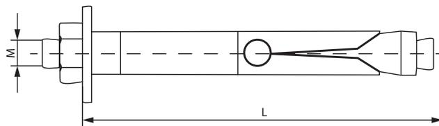
El funcionamiento es el mismo que los anclajes metálicos con tornillo. Es necesario realizar un taladro previamente donde ubicar el anclaje y, mediante la expansión de la camisa, una vez realizado el roscado del espárrago, se produce el anclaje por presión en las paredes del material base. A través de la tuerca que incorpora permite fijar el elemento a sujetar o fijar.
