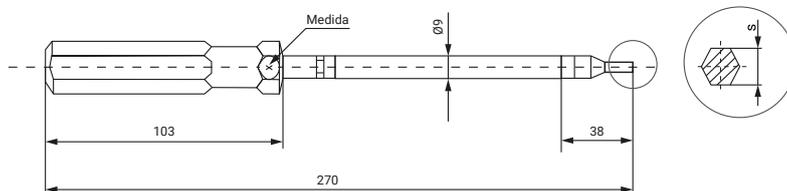
Destornillador con un vástago flexible y con vaso hexagonal que permite realizar el apriete del tornillo de las abrazaderas aunque el destornillador no esté completamente en línea con el tornillo. Su mango es ergonómico y de un material que permite un agarre perfecto y que no se deslice durante su uso.
