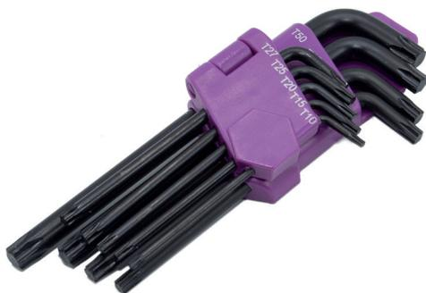
La llave Torx de seguridad es una herramienta que se utiliza para poder roscar con efectividad toda clase de tornillos que tengan en la cabeza una huella análoga a la de la llave citada. Este tipo de llave resiste el efecto "cam-out" o salida que se produce cuando el destornillador tiene cierto par de apriete y resbala en el tornillo.
