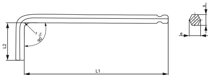
Esta llave Allen en el extremo corto es hexagonal como las llaves convencionales pero en el extremo largo su terminación es con una bola. Esta terminación permite realizar el apriete cuando la llave no está completamente alineada con el tornillo y el acceso al tornillo resulta complicado por falta de espacios. Fabricadas en acero cromo vanadio que mejora la resistencia al desgaste siguiendo la normativa DIN 911.
