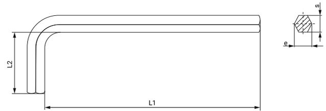
La llave Allen DIN 911 larga es una herramienta que se utiliza para poder roscar con efectividad toda clase de tornillos que tengan en la cabeza un hueco hexagonal adaptado para poder introducir dicha llave. Se trata de una llave cuyo modelo tiene un brazo mucho más largo que el de su análogo estándar para hacer posible que se pueda llegar a un espacio de difícil acceso.
