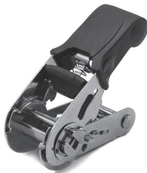
El aparato trincaje es un accesorio metálico diseñado con mecanismos articulados aptos para tensar cintas de amarre. Es un accesorio imprescindible para la funcionalidad de los sistemas de trincaje para cargas pesadas, además, su correcta aplicación evita posibles daños por golpes, rozaduras, desplazamientos o vuelcos durante el transporte de la carga.
