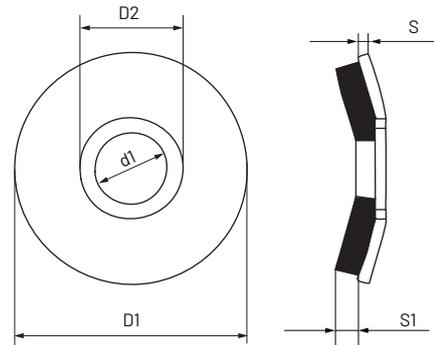
Las arandelas conjuntas están fabricadas en acero galvanizado y cuentan con un recubrimiento en EPDM. EL EPDM es un caucho que se adhiere a la arandela y que tiene una alta resistencia a los ambientes atmosféricos e impermeabiliza la aplicación.
