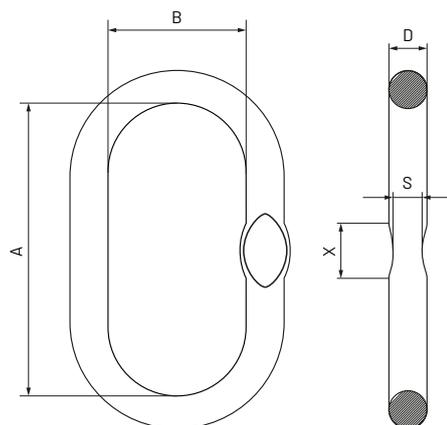
La anilla maestra oval es indispensable para aquellas aplicaciones donde se precise ensamblar eslingas de cadena o cable. Gracias a la calidad del material con el que está realizado, puede soportar grandes cargas de trabajo.
