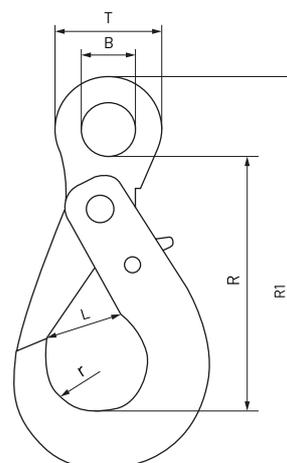
El gancho de autocierre es el adecuado para usarse con cadenas grado 80. El dispositivo de autocierre permite obtener la máxima garantía por lo que a seguridad se refiere. La propia fuerza de tracción de la carga impide su apertura accidental. En el modelo con horquilla y pasador, este facilita la movilidad direccional de la carga.
