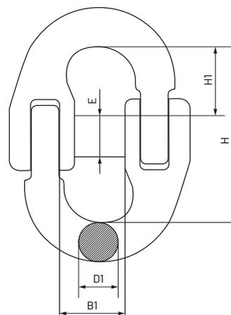
Gracias a su diseño articulado, y sin necesidad de útiles especiales, podemos ensamblar y desensamblar, e incluso prolongar con mucha rapidez y eficacia, la unión de cadenas para elevar o transportar elementos, estructuras o artugios pesados. La firmeza de la fijación queda garantizada gracias a la excelente funcionalidad del seguro que actúa a modo de retención en la parte central del pasador y de tope contra las dos paredes internas de la parte donde se produce la articulación.
